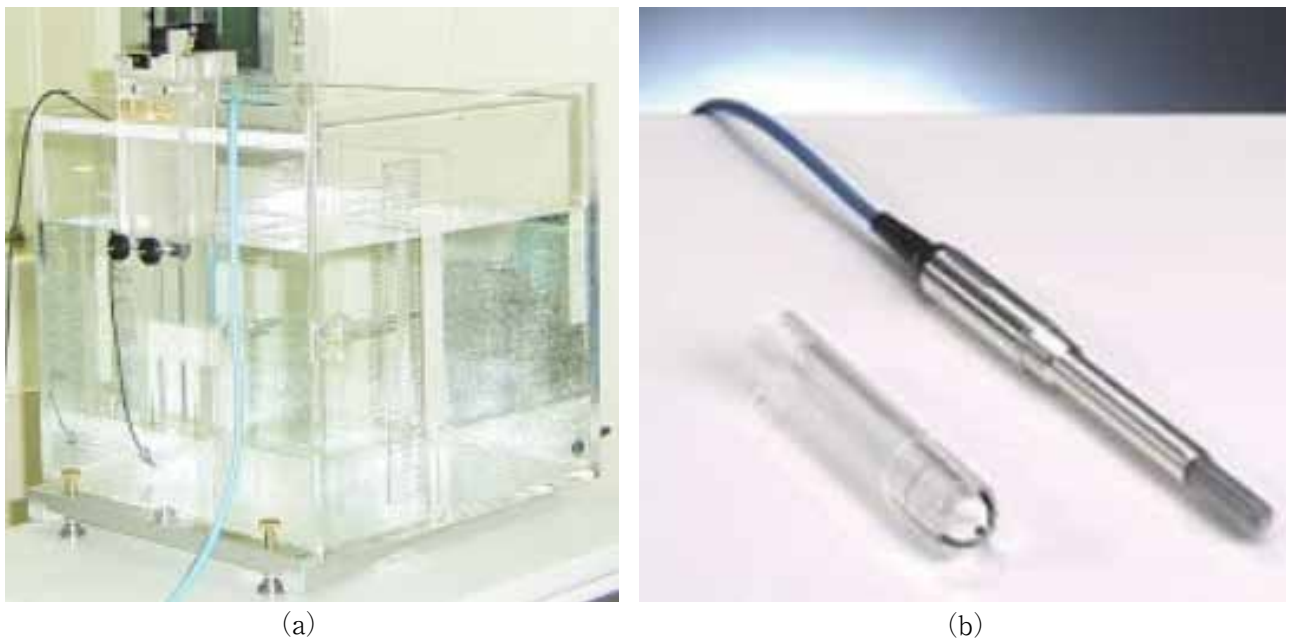
図2 測定の概要。(a) は水ファントムと呼ばれる水槽である。(b) は電離箱であり、放射線の量を測定するのに用いる。本研究では、水中10cmの深さに電離箱を設置してデモプランを照射したときの線量を測定した。
